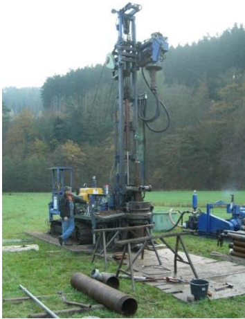
Kernbohrgerät auf Kettenfahrwerk
